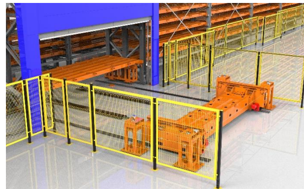
Рис 9. Станция выдачи с выкатным столом
