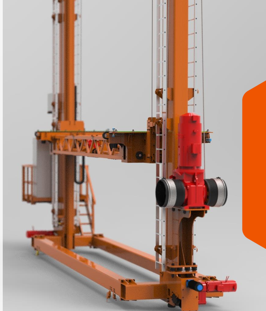
Рис 4. Привод подъема крана-штабелера с тяговым экстрактором
