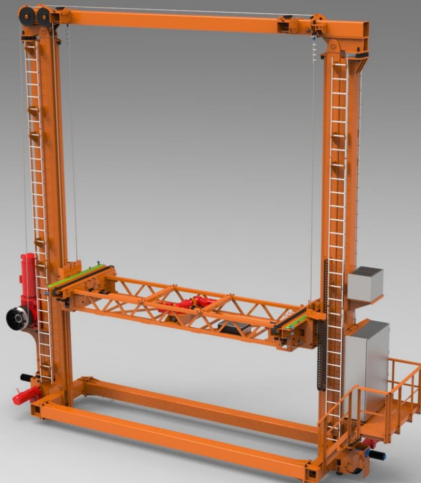
Рис 5. Общий вид крана-штабелера с тяговым экстрактором
