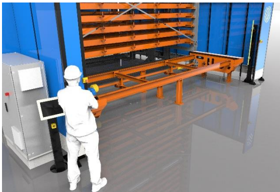
Рис 8. Станция выдачи ТМЦ с внешним окном
