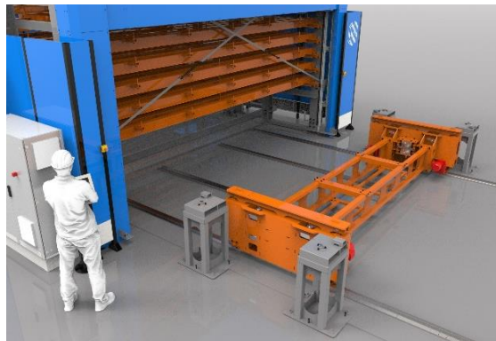
Рис 9. Станция выдачи с выкатным столом
